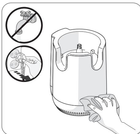
※ После полного завершения работы, выньте вилку шнура питания из розетки сухими руками. Даже после выключения изделия двигатель останавливается медленно, поэтому подождите около 3 секунд, прежде чем снять узел отжимной камеры.
